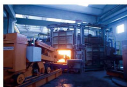
Barra de Acero Corte y calentamiento
