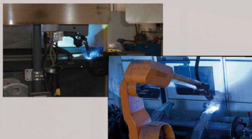
Soldadura ejes y direccionales
