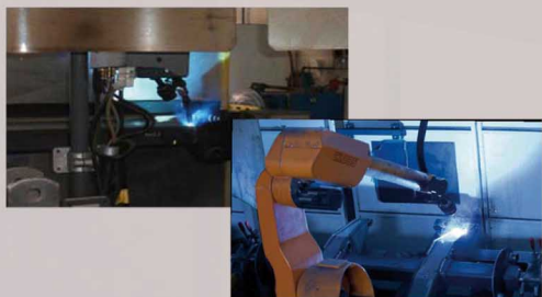
Soldadura ejes y direccionales
